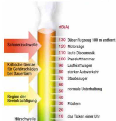
Abbildung 2: „Lärmometer“ (verschiedene Schallereignisse und deren Schalldruckpegel) [Amt für Luft und Lärm Bozen 2001]
