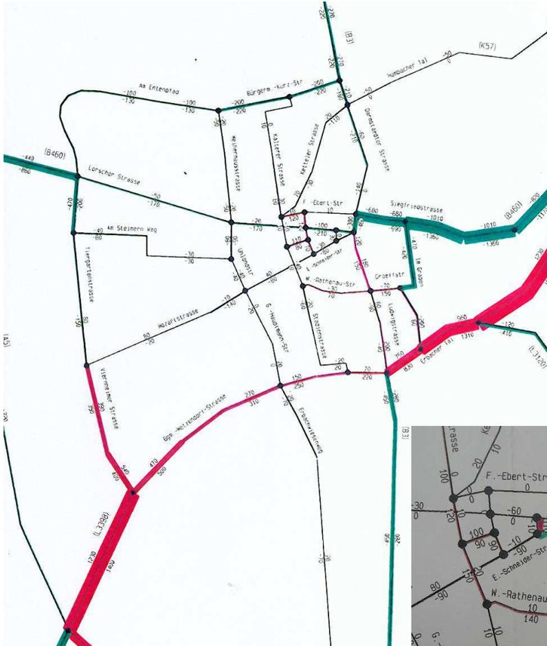
Die große Verkehrsmengenkarte aus dem Verkehrswegeplan weist die Verkehrsverlagerungen bei Bau eines Maibergtunnels zusammen mit einer AS-Süd nach (Rot Zunahmen – grün Abnahmen). Eine starke Entlastung der Siegfriedstraße sowie des Postplatzes wird rechnerisch ebenso nachgewiesen, wie die 50%ige Entlastung des Grabens.
